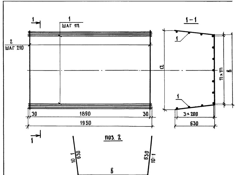
КАРКАСЫ ИЗГОТОВИТЬ ИЗ ГНУТЫХ СТВЕРЖНЕЙ
