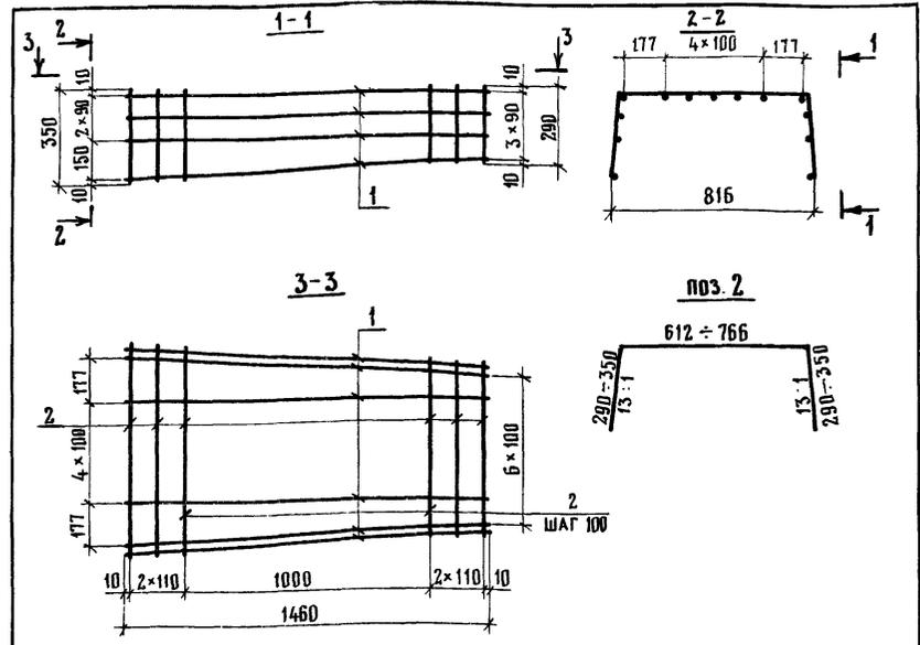
Каркас изготовить из гнутых стержней
